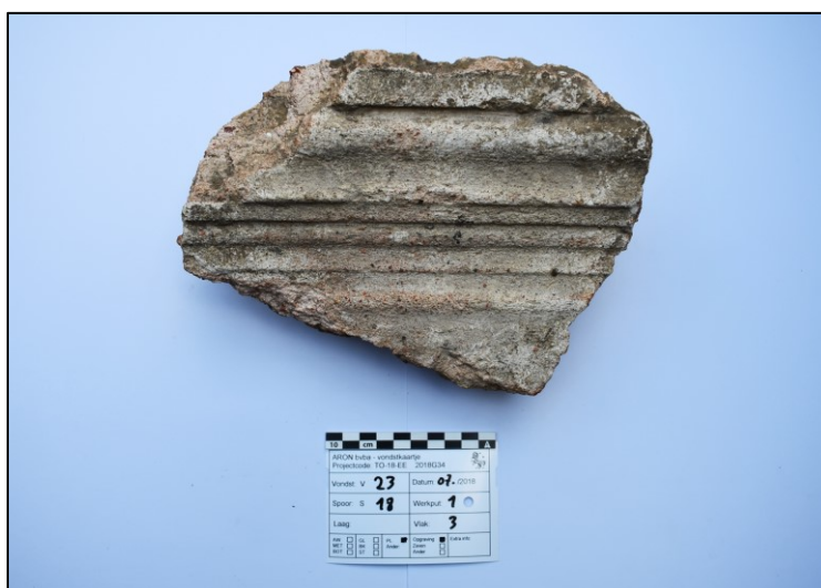
Afb. 85.: een moulure uit mortel en pleister.
